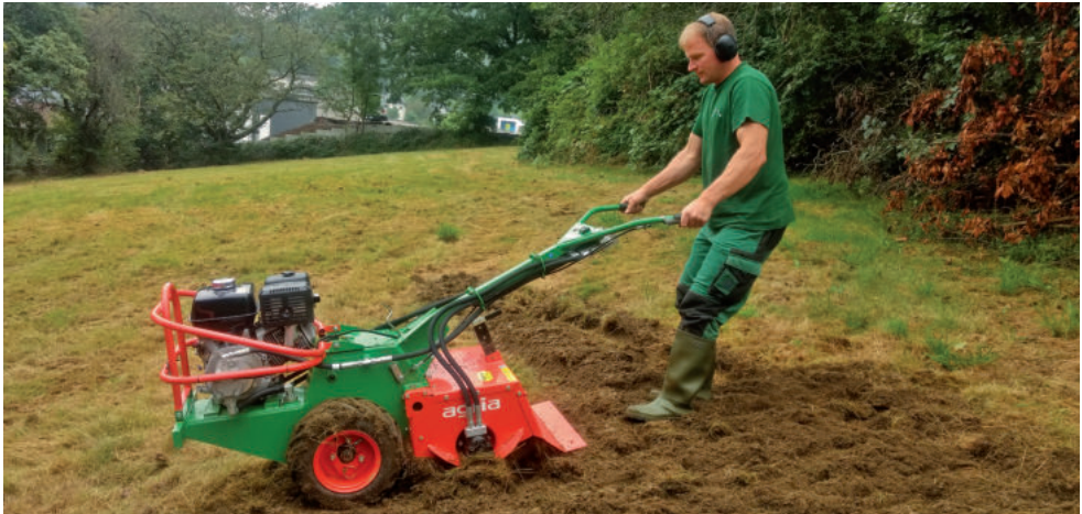
Eine sogenannte Umkehrfräse erleichtert die Vorbereitung des Saatbettes.
